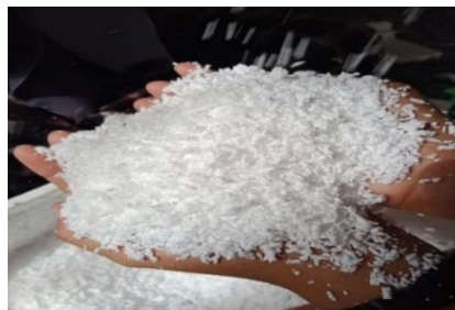
Gambar 2 Styrofoam yang sudah dihaluskan
