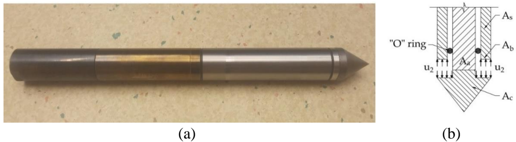
Gambar 1. Cone penetration piezoelectric test, (a) konus CPT (b) Skema pengukuran tekanan air pori pada penampang: A_a , A_b , A_c , A_s (Mihálik et al., 2023).
